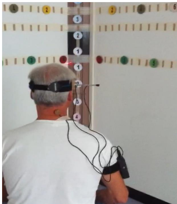
Sesja sprint z użyciem inklinometru, wskaźnika laserowego i brzęczyka.
